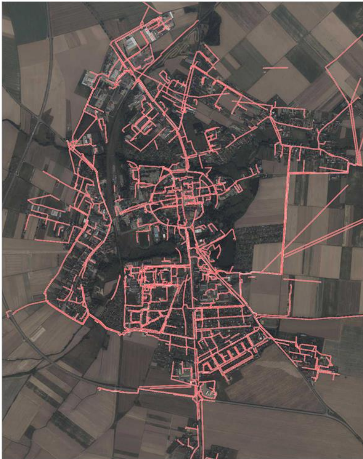
Rysunek 9. Schemat sieci elektroenergetycznej na terenie Grodkowa
