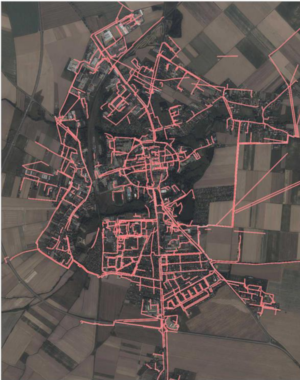
Rysunek 9. Schemat sieci elektroenergetycznej na terenie Grodkowa
